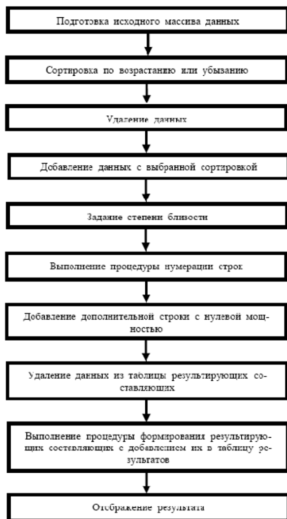
Рис. 1. Структура алгоритма построения математической модели
