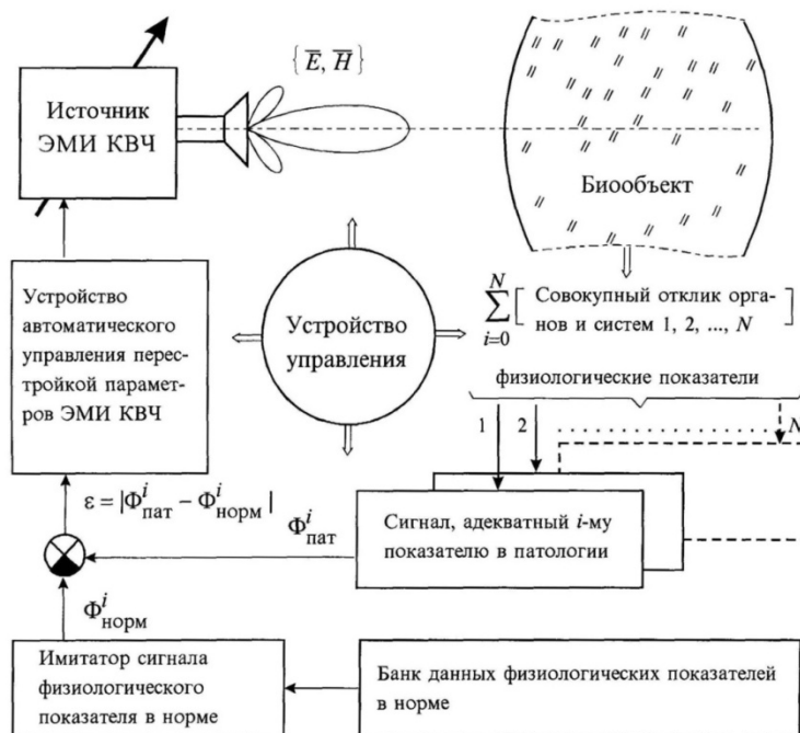
Рис. 10. Обобщенная схема эксперимента по выявлению эффектов электромагнитного биорезонанса с вариацией характеристик облучающего ЭМИ КВЧ
