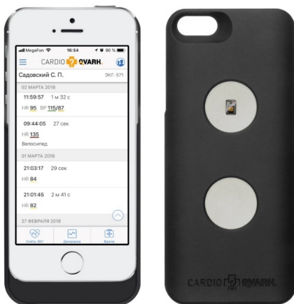
Рис. 3. Общий вид электрокардиографа CardioQVARK
