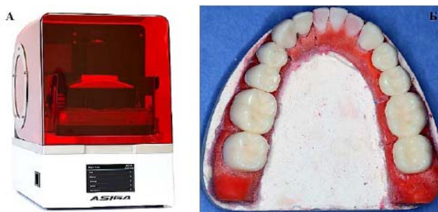
Рис. 4. А. 3D принтер Asiga Max UV . Б. Временные искусственные коронки, изготовленные из микронаполненного гибридного материала NextDent C&B MFH
