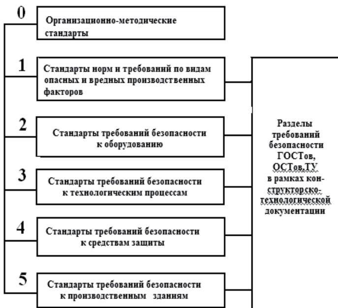
Рис. 3. Структурная схема Системы стандартов безопасности труда.
