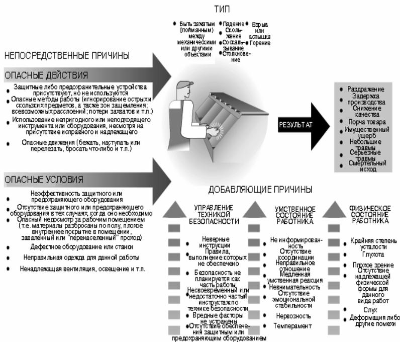
Рис. 9. Структура непосредственных и добавляющих причин несчастного случая
