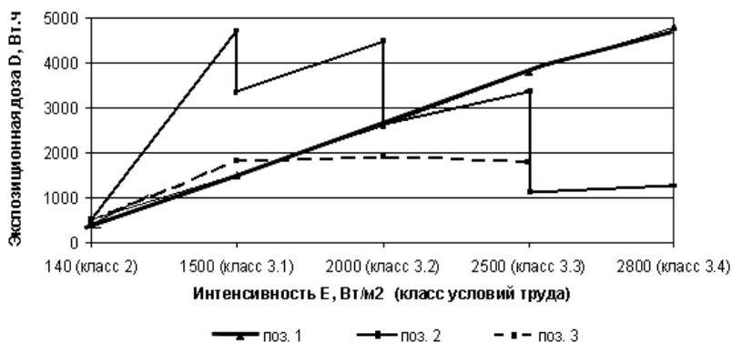
Рис. 43. Графики экспозиционной дозы теплового облучения в различных классах условий труда
