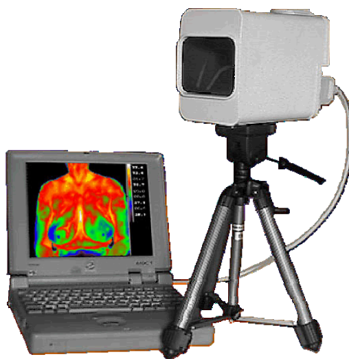
Рис. 7. Портативный компьютерный термограф ИРТИС-2000
